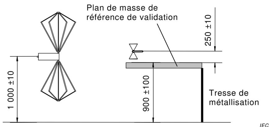
Figure J.6 – Vue de côté de la configuration de l'antenne pour la mesure de référence supérieure ou égale à 30 MHz (l'antenne biconique étant présentée à titre d'exemple)
