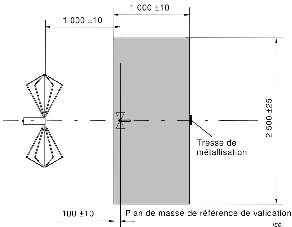
**Figure J.5 – Vue de dessus de la configuration de l'antenne pour la mesure de référence supérieure ou égale à 30 MHz (l'antenne biconique étant présentée à titre d'exemple)**
