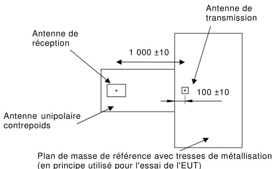
Figure J.7 – Vue de dessus de la configuration de l'antenne pour la mesure de l'ALSE inférieure à 30 MHz
