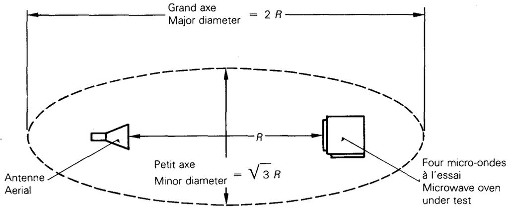
La limite de l'emplacement d'essai est décrite par une ellipse. L'espace situé au-dessus de l'emplacement d'essai ne doit contenir aucun objet réflecteur.
