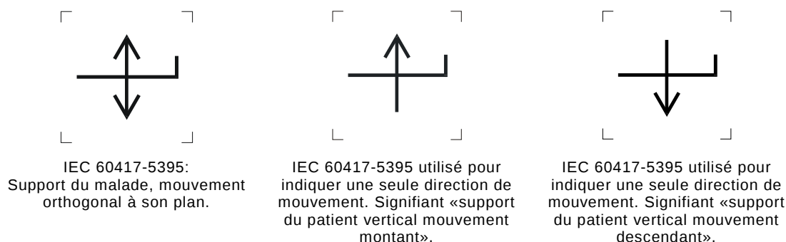
Figure 6 – Exemple d'utilisation d'une seule direction de mouvement
