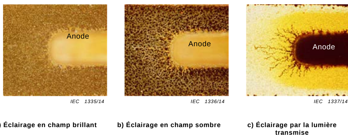
Figure 56 – Images de dendrite observées par différentes méthodes d'éclairage (sans masque de soudure)
