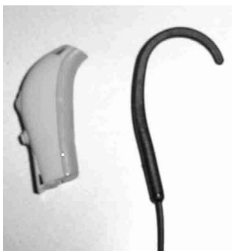
Figure 1 – Un transducteur d'induction auriculaire, avec un corps d'appareil de correction auditive contour d'oreille pour fournir une échelle
