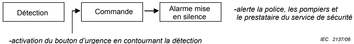
Figure B.2 – Configuration du système pour le fonctionnement en mode d'urgence
