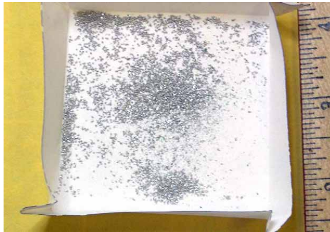
Figure E.12 – Matériau de bille de soudure recueilli d'un BGA en utilisant une procédure de retrait manuel
