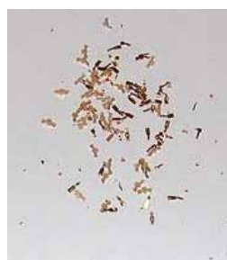
Figure E.9b – Conducteurs métalliques après désassemblage
