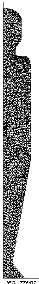
Figure E.5 – Maillage du corps en utilisant la méthode des éléments finis
