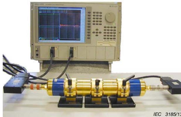
**Figure 72 – S parameter test setup**
