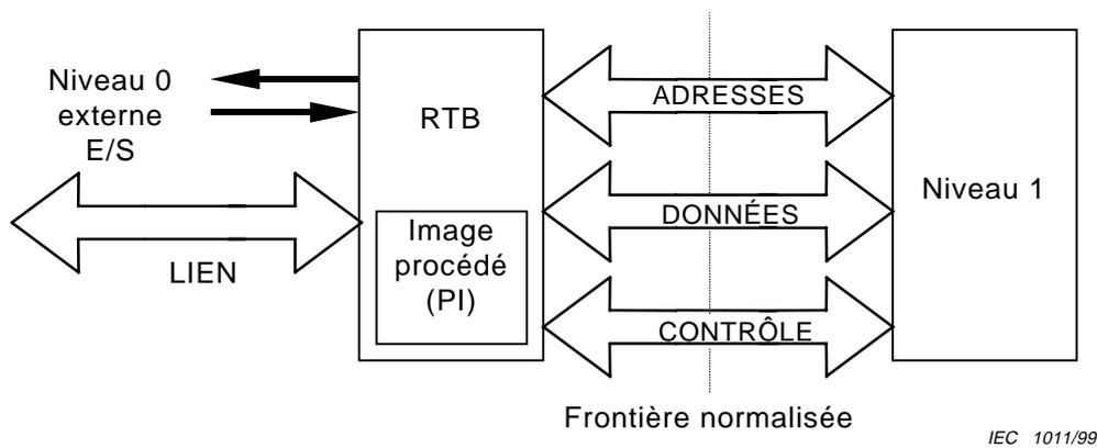
Figure 14 – Interface RTB – équipement de niveau 1
