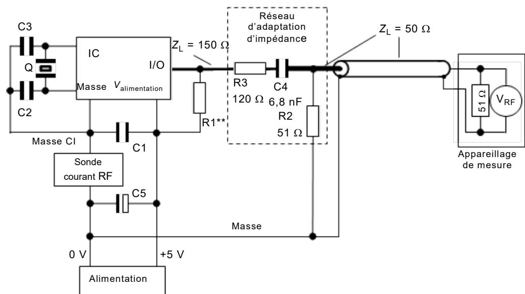
\*\* Une résistance de polarisation à l'alimentation/à la masse peut être requise en fonction de l'application
