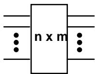
NOTE – Illustration d'un dispositif à branchement en étoile de  $n \times m$  branches. On peut préciser  $n$  et  $m$ . Une version passive de ce dispositif est quelquefois appelée mélangeur optique.
