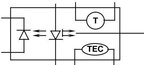
NOTE – Illustration d'une diode laser, d'un thermistor, d'un réfrigérateur thermoélectrique (TEC) et d'une amorce de fibre optique.
