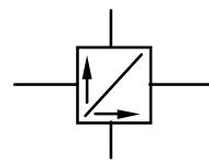
NOTE – Ce symbole s'applique à un séparateur optique cubique en vrac. Ce dispositif étant réversible, les flèches peuvent être inversées pour indiquer un mélangeur optique ou un multiplexeur.
