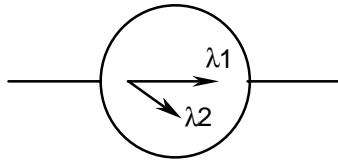
NOTE – La position normalement fermée représente un interrupteur qui, à l'état de repos, bloque une longueur d'onde de lumière  $\lambda_2$  et permet à une longueur d'onde de lumière  $\lambda_1$  de parcourir la fibre. En actionnant l'interrupteur, on autorise la longueur d'onde de lumière  $\lambda_2$  à parcourir la fibre et à bloquer la longueur d'onde de lumière  $\lambda_1$ .
