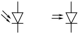
NOTE – Également appelé détecteur PIN. Voir diode électroluminescente pour un exemple de fibre amorce.
