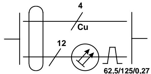
NOTE – Exemple de câble composite contenant à la fois des conducteurs en cuivre et des fibres optiques, avec complément d'informations. Cet exemple particulier montre un câble composite contenant quatre conducteurs en cuivre et 12 fibres optiques multimodes à gradient d'indice, chacun ayant un diamètre de cœur de 62,5 µm, un diamètre de gaine de 125 µm, et une ouverture numérique de 0,27.
