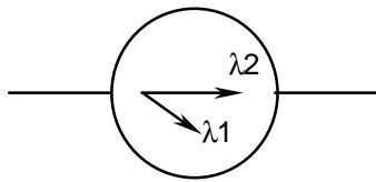
NOTE – La position normalement fermée représente un interrupteur qui, à l'état de repos, bloque une longueur d'onde de lumière  $\lambda_1$  et permet à la longueur d'onde de lumière  $\lambda_2$  de parcourir la fibre. En actionnant l'interrupteur, on autorise la longueur d'onde de lumière  $\lambda_1$  à parcourir la fibre et à bloquer la longueur d'onde de lumière  $\lambda_2$ .
