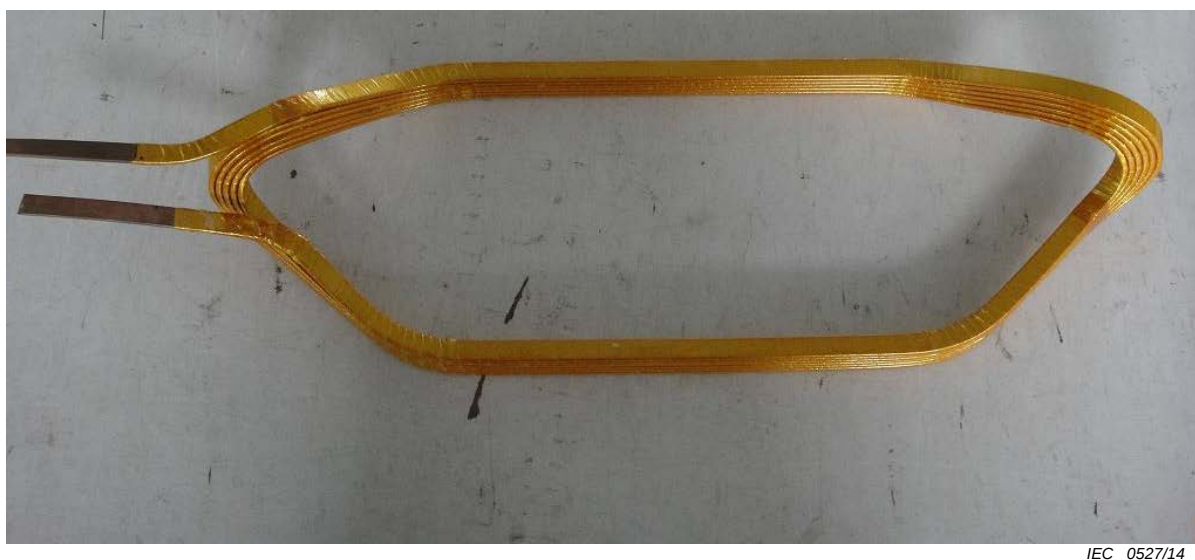
Figure B.5 – Bobine formée avec couche de protection retirée
