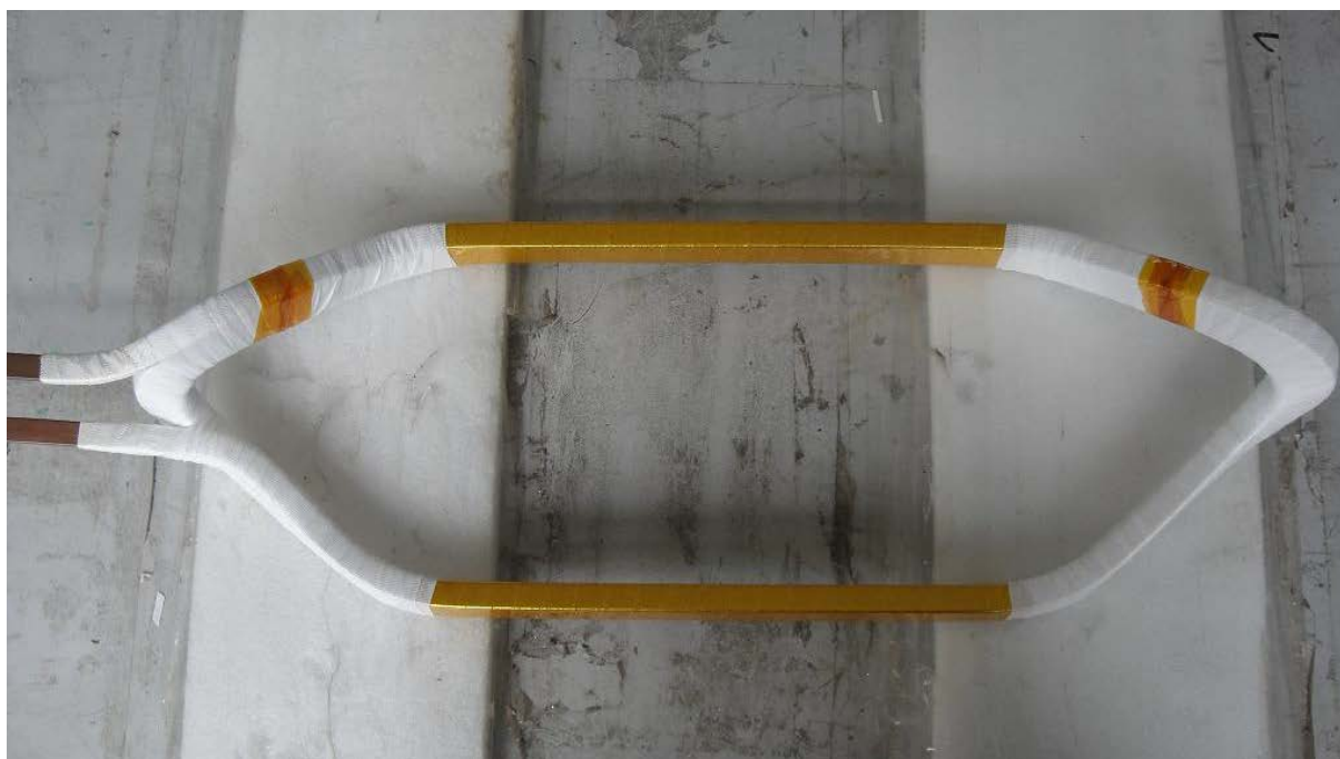
Figure B.6 – Gros plan d'une isolation à emboîtement pour bobines formées
