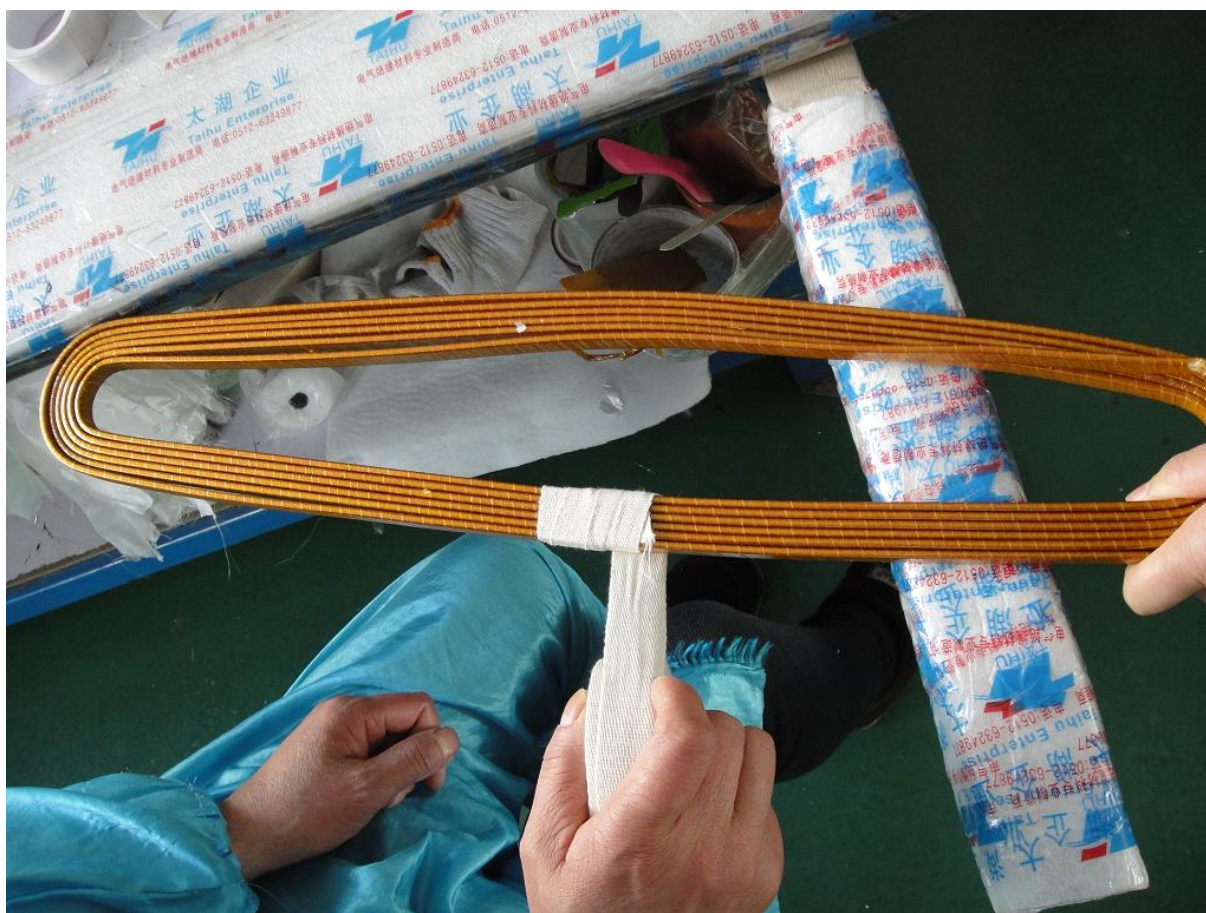
Figure B.2 – Bobine non préformée, enveloppée par un tissu de protection
