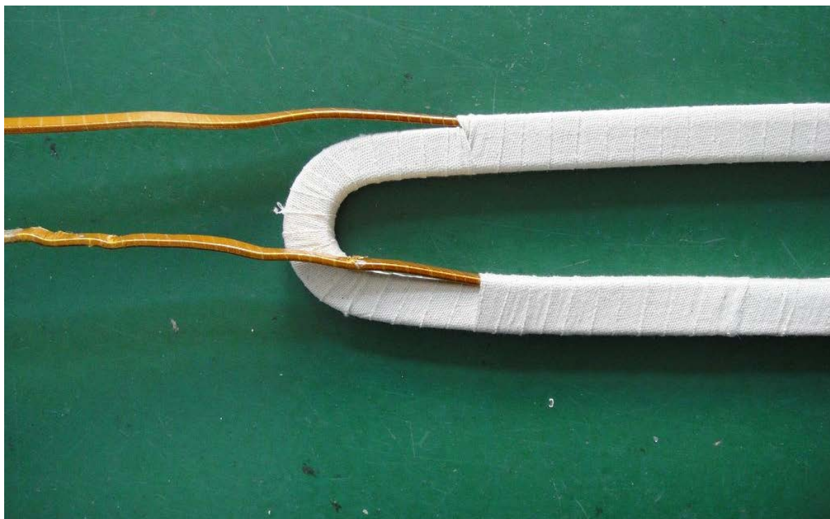
Figure B.2 – Bobine non préformée, enveloppée par un tissu de protection
