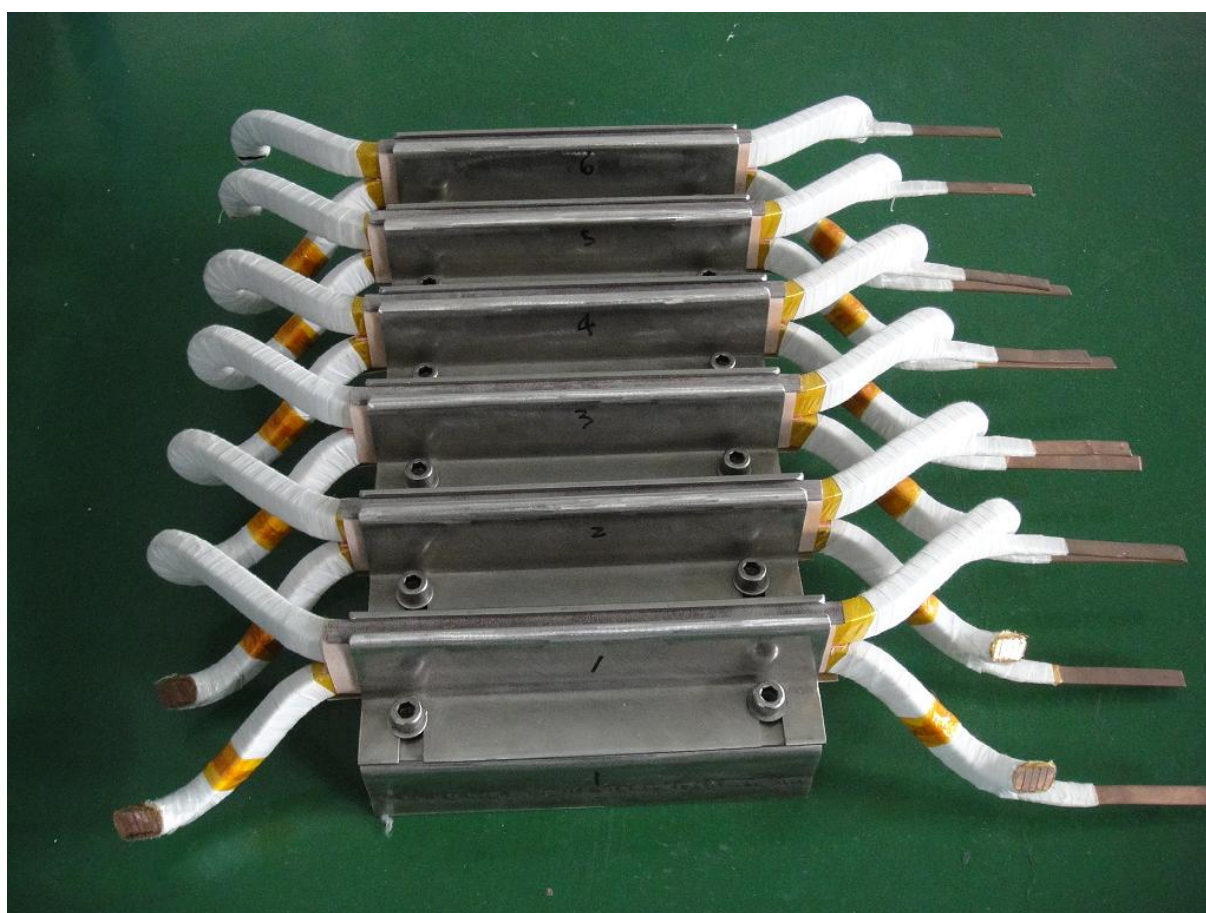
Figure B.8 – Bobines formées placées dans l'éprouvette d'essai à enroulement préformé ou Formette
