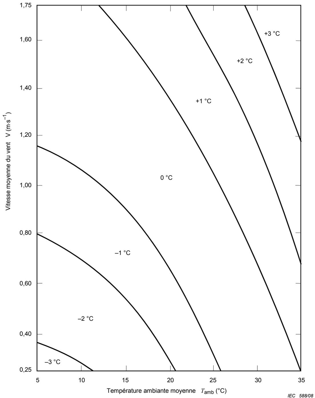
Figure 2 – Facteur de correction de NOCT
