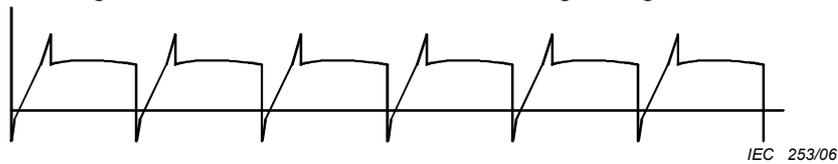
Figure 6e – Auto-communication: tension ligne à terre
