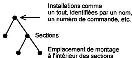
Figure 22 - Structure adaptée à l'emplacement à l'intérieur d'une unité de montage
