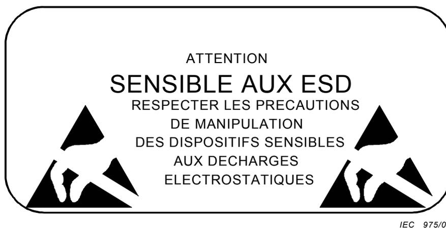
Figure A.2 – Etiquette indiquant qu'un produit est sensible aux ESD
