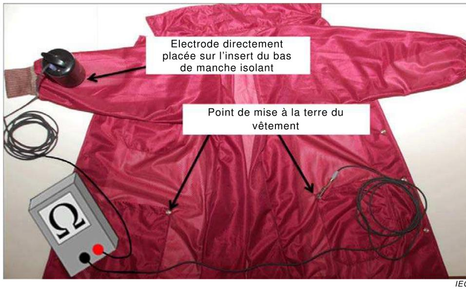
**Figure 9 – Montage d'essai – Résistance point à point pouvant être relié à la terre (procédure appliquée entre le bas de manche et le point pouvant être relié à la terre avec inserts de bas de manche isolants)**
