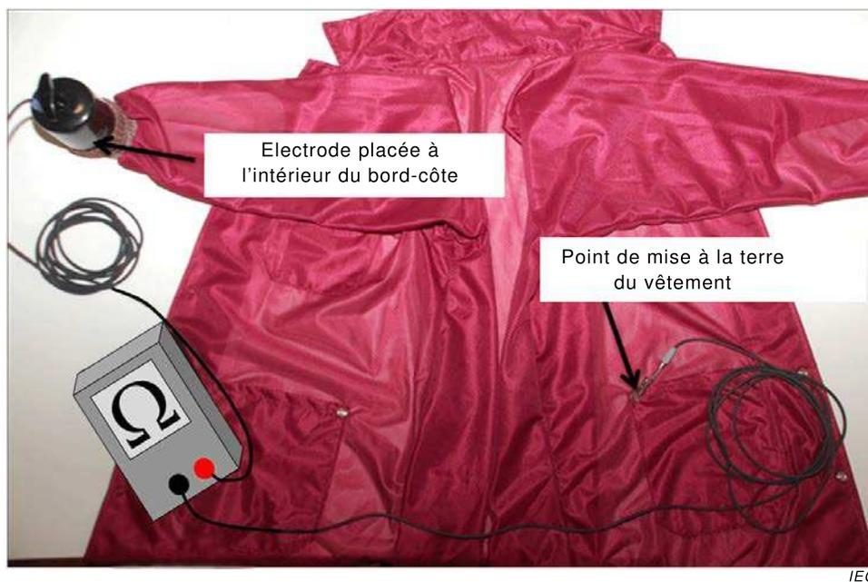
Figure 8 – Montage d'essai – Résistance point à point pouvant être relié à la terre (procédure appliquée entre le bord-côte et le point pouvant être relié à la terre avec inserts de manche isolants)
