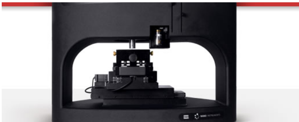
Figure A.1 – Exemple de système d'essai de nanoindentation
