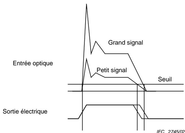
Figure 4 – Obliquité du récepteur à partir de la différence de niveau optique
