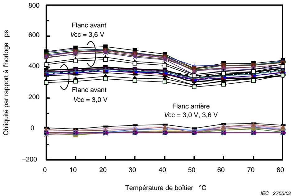
Figure 14 – Dépendance de température de l'obliquité d'émetteur
