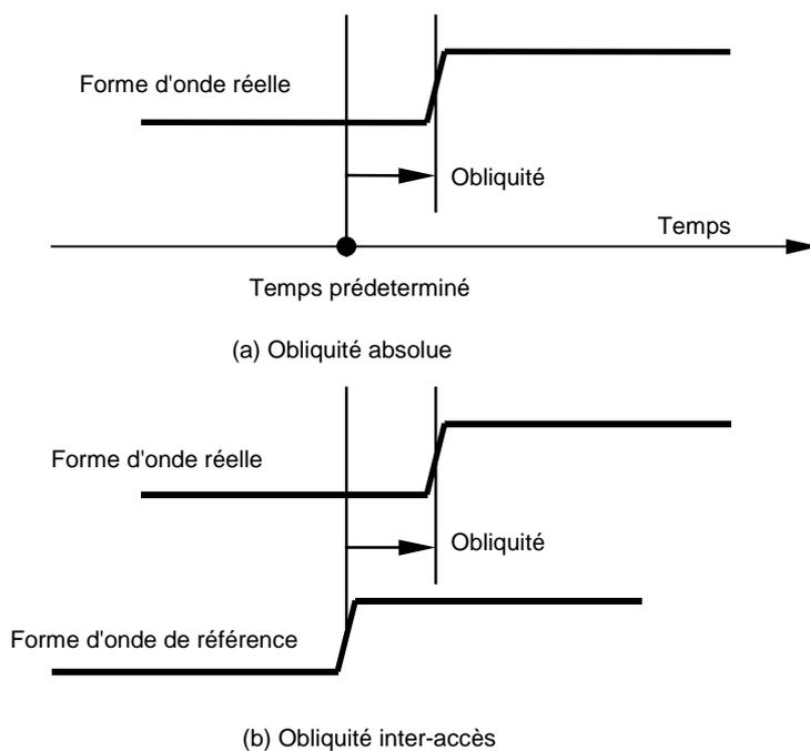
**Figure 3 – Définition d'obliquité en interconnexion optique parallèle**
