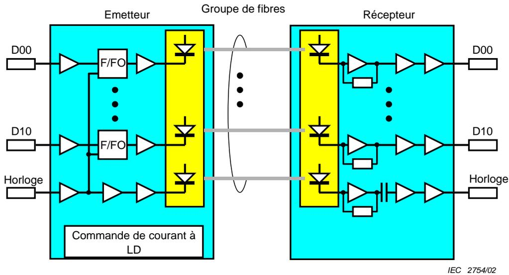
Figure 13 – Schéma du module d'émetteur et récepteur
