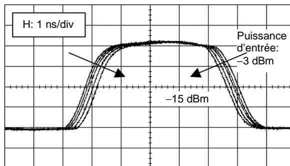
Figure 16 – Exemple d'obliquité de récepteur affectée par le niveau de puissance de réception
