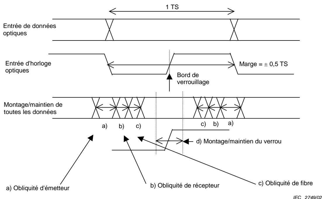
**Figure 8 – Schéma d'explication d'obliquité en cas de transmission d'horloge simultanée**
