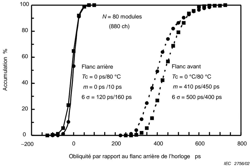
Figure 15 – Courbe d'accumulation d'obliquité d'émetteur à température de boîtier de  $0 \text{ °C}$  et  $80 \text{ °C}$
