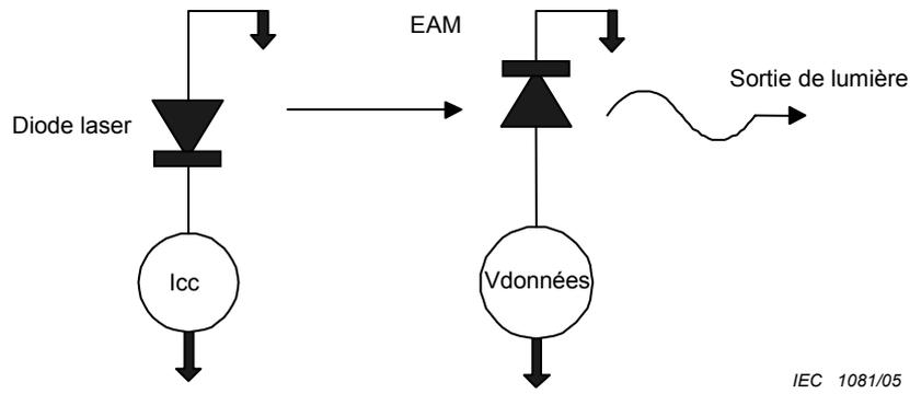
Figure B.3 – Représentation schématique d'un laser modulé à électro-absorption
