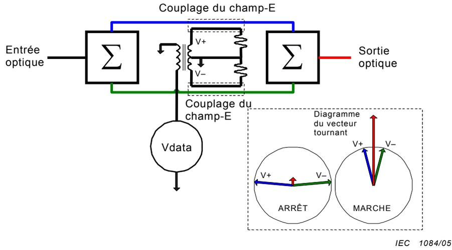
Figure B.6 – Représentation schématique d'un modulateur de Mach-Zehnder
