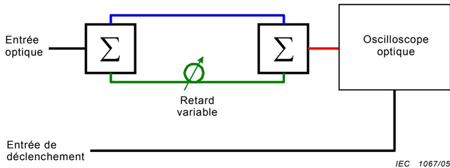
Figure 2 – Schéma simplifié de la méthode du discriminateur en fréquence
