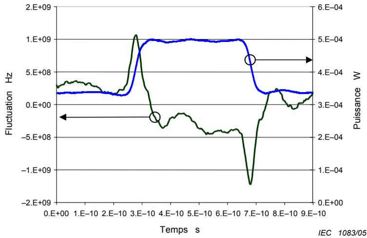
**Figure B.5 – Fluctuation de la longueur d’onde d’un laser modulé à électro-absorption avec une caractéristique transitoire supplémentaire**
