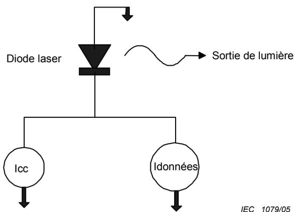
**Figure B.1 – Représentation schématique d'un laser modulé directement**
