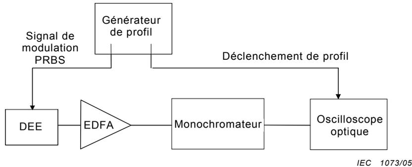
Figure 8 – Montage de la méthode du monochromateur
