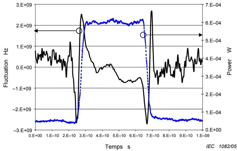
Figure B.4 – Fluctuation de la longueur d'onde d'un laser modulé à électro-absorption avec une fluctuation de la longueur d'onde transitoire normale
