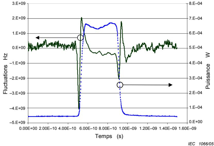
Figure 1 – Mesure type de la fluctuation de la longueur d'onde résolue dans le temps
