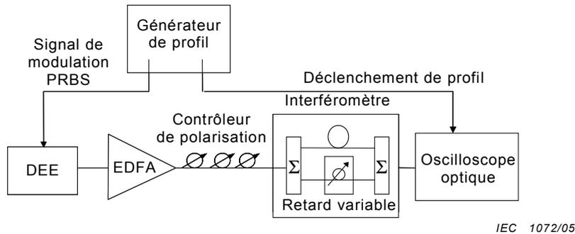
**Figure 7 – Montage de la méthode du discriminateur en fréquence**
