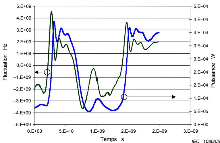
Un laser modulé directement a une fluctuation de la longueur d'onde transitoire et adiabatique significative.
