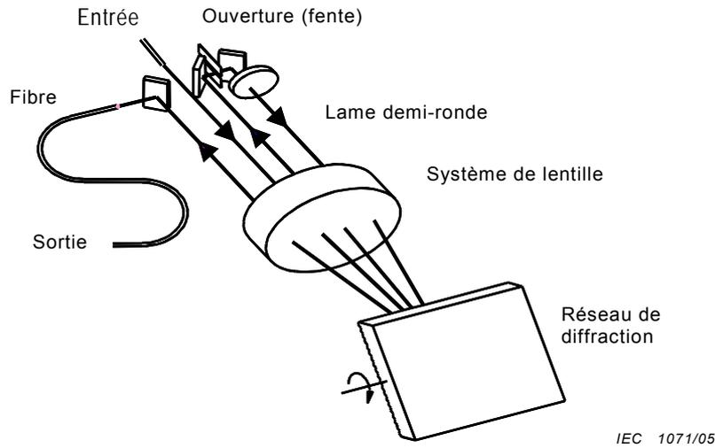
Afin d'obtenir une dispersion faible, une configuration à double pas est généralement utilisée.
