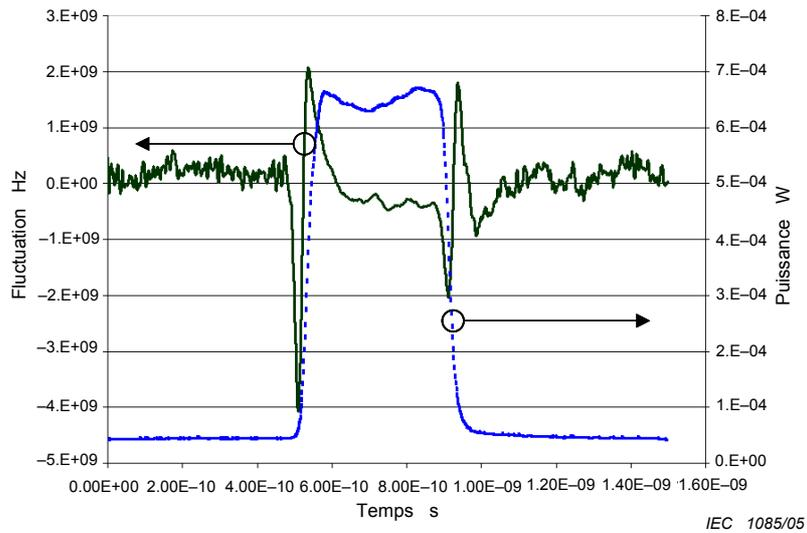
Figure B.7 – Mesure de la fluctuation de la longueur d'onde sur un modulateur de Mach-Zehnder présentant uniquement une fluctuation de la longueur d'onde transitoire
