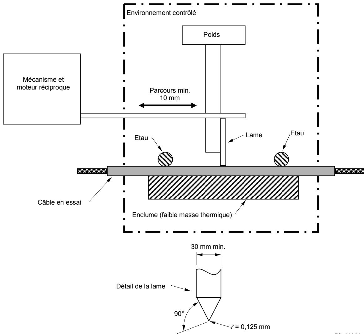
**Figure 1 – Installation et montage de l'essai d'abrasion par frottement**
