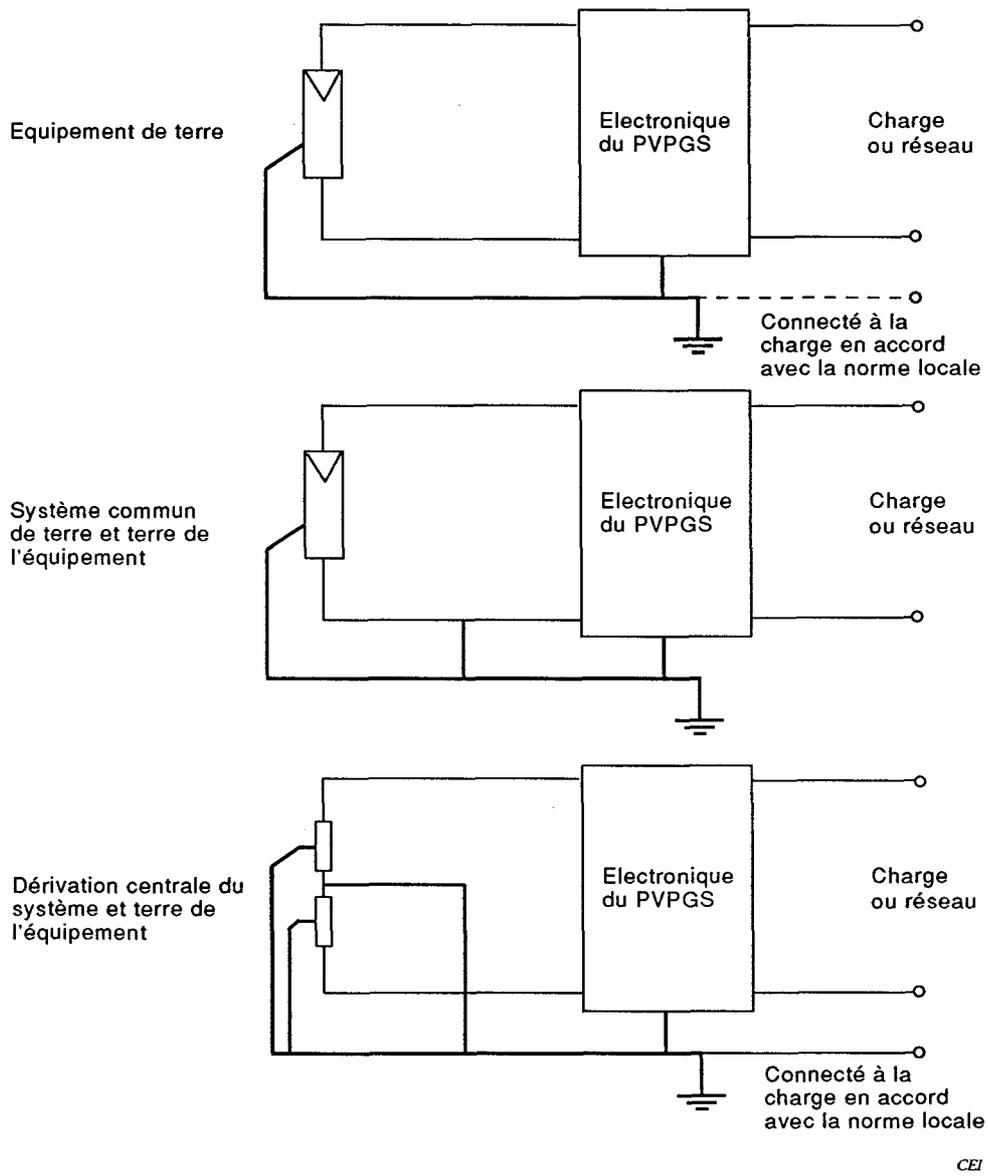
Figure 2 – Exemple de trois méthodes classiques utilisées pour la mise à la terre des PVPGS
