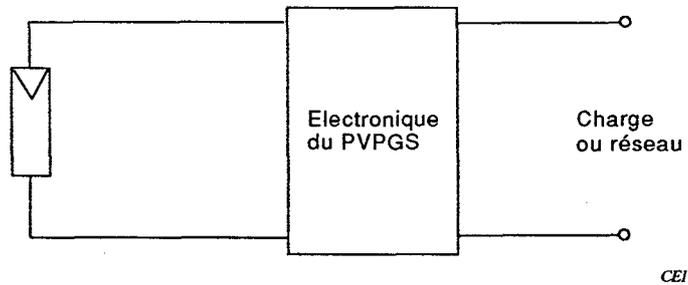
Figure 3 – Exemple de PVPGS n'ayant pas de mise à la terre
