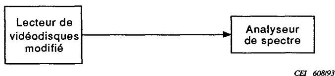
Figure S.1 – Schéma synoptique du dispositif de mesure
