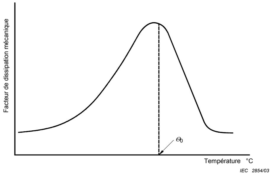
Figure 5 – Courbe typique du facteur de dissipation thermique
