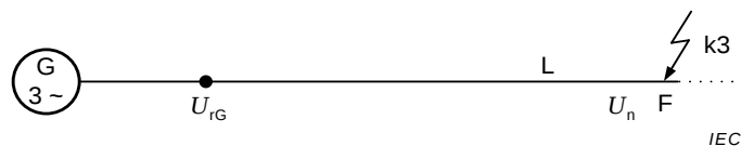
Figure 8b – Court-circuit alimenté depuis un alternateur
