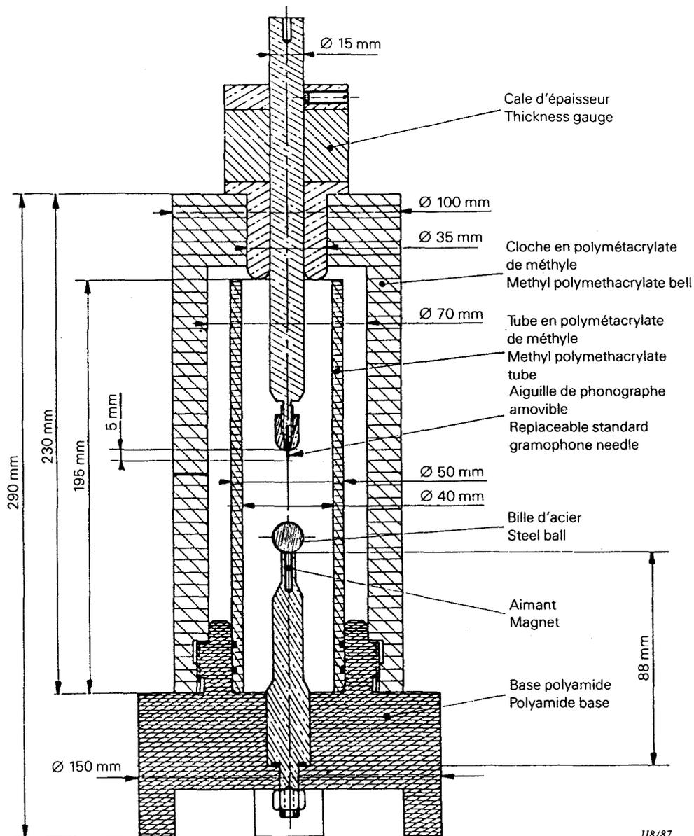
FIG. 1.— Système d'électrodes pointe-sphère pour essais de choc de liquides isolants.
