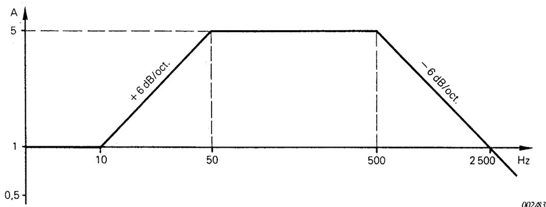
La courbe de pondération est calculée sur un étage de synchronisation stabilisée horizontale d'un récepteur ayant un gain minimal de 16 000, une fréquence de résonance de 160 Hz ainsi qu'un facteur d'atténuation de 1,6.
