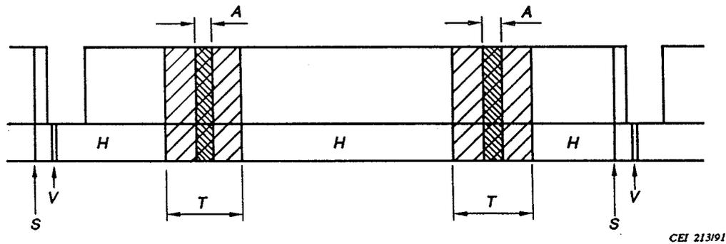
Figure 1 - Transitions du signal (une trame) - Une seule tête vidéo est utilisée par balayage (voir 6.1.2 a))
