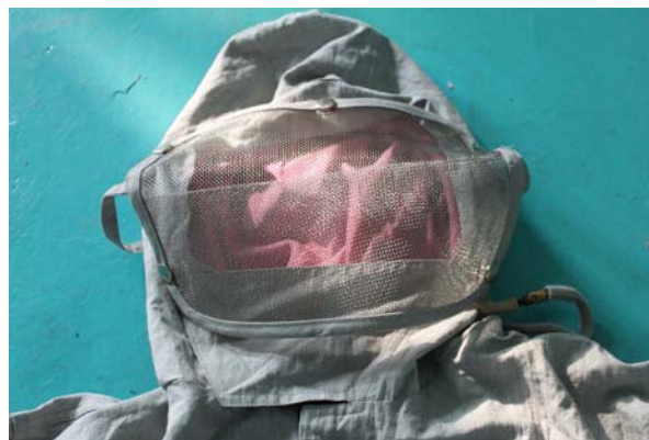
Masque grillagé relié électriquement au vêtement conducteur — Face screen electrically bonded to the conductive clothing
