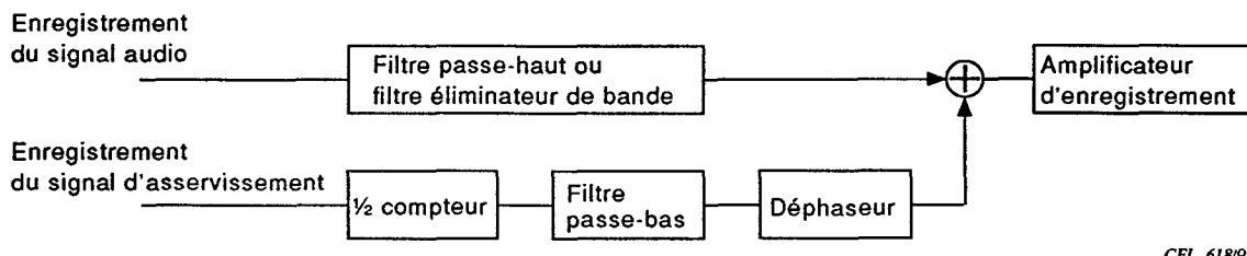
Schéma fonctionnel d'enregistrement du signal pilote de réduction de bruit
