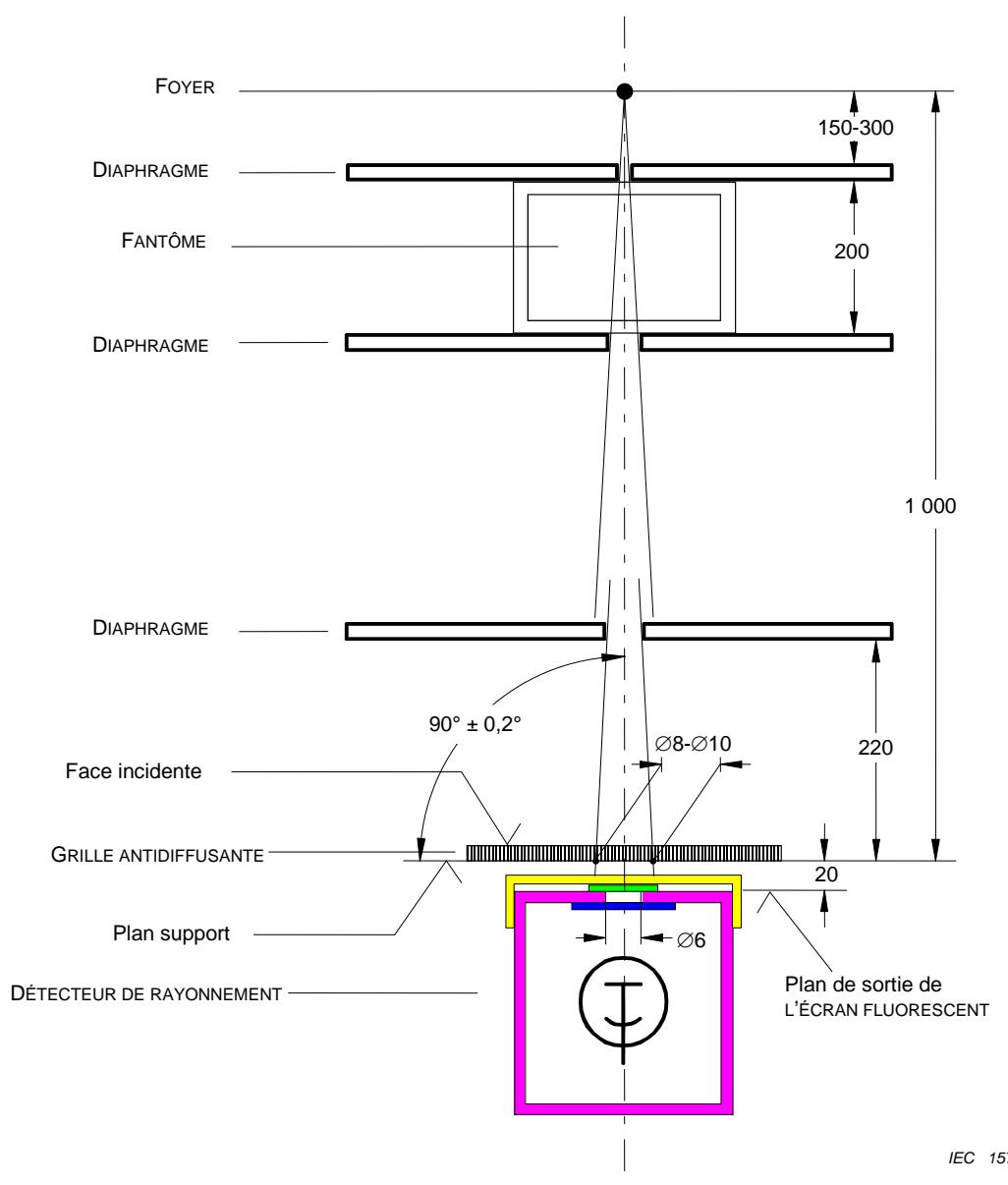
**Figure 3 – Montage de mesurage pour les GRILLES ANTIDIFFUSANTES d'usage général avec CONDITION DE FAISCEAU ETROIT (détermination de la TRANSMISSION DU RAYONNEMENT PRIMAIRE)**
