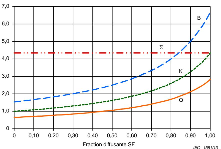
**Figure B.1 – Caractéristiques physiques déterminées en fonction de fraction diffusante: SELECTIVITE  $\Sigma$  (pointillés-tirets), FACTEUR D'AMELIORATION DU CONTRASTE  $K$  (pointillés), FACTEUR D'EXPOSITION DE GRILLE  $B$  (tirets) et FACTEUR D'AMELIORATION DE L'IMAGE  $Q$  (ligne)**
