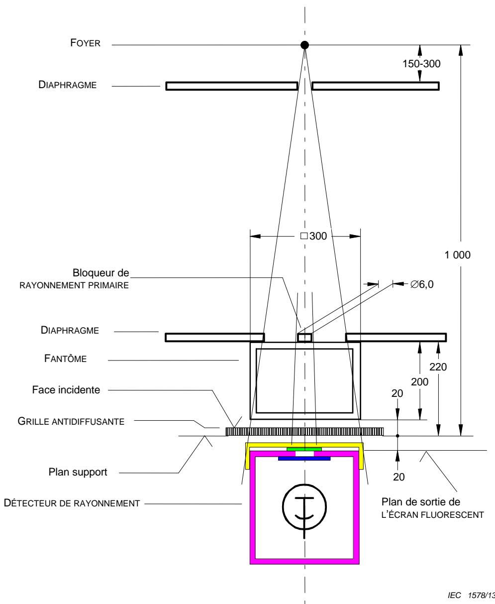
**Figure 4 – Montage de mesure pour les GRILLES ANTIDIFFUSANTES d'usage général avec CONDITION DE FAISCEAU LARGE (détermination de la TRANSMISSION DU RAYONNEMENT DIFFUSE)**
