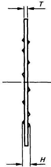
FIG. 11. — Rondelles à dents à simple denture intérieure pour filets dont les dimensions d'origine sont en inches.
