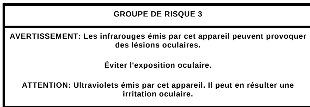
Figure 201.101 – Exemple de plaque indicatrice pour un appareil présentant plusieurs régions spectrales de DANGER
