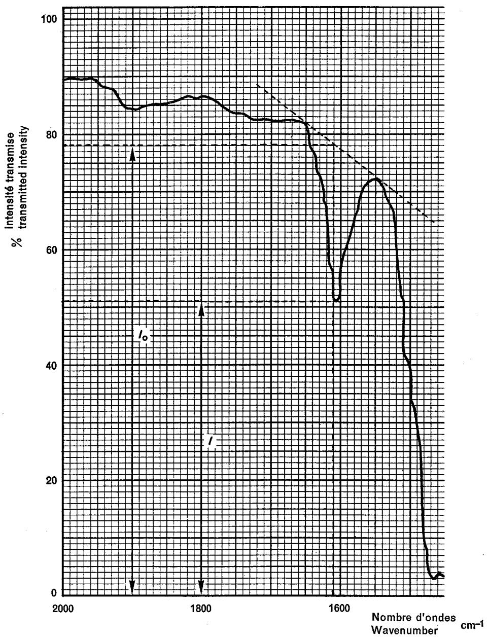
FIG. 1. — Exemple de spectre infrarouge pour déterminer la teneur en hydrocarbures aromatiques.
