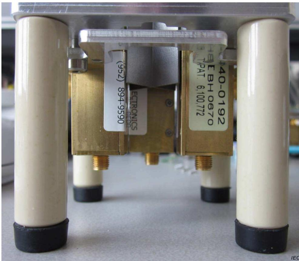
Figure A.7 – Tête d'essai représentant un blindage entre des symétriseurs
