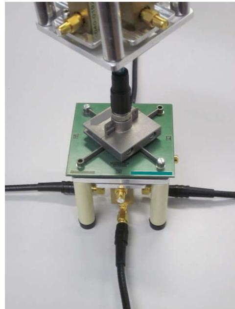
**Figure 13 – Mesure d'affaiblissement de réflexion et de paradiaphonie sur le dispositif en essai**
