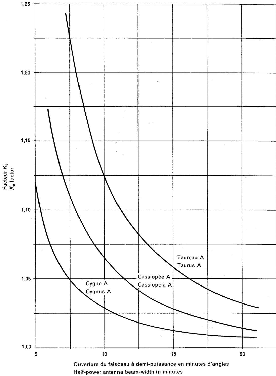
FIG. 2. — Facteur  $K_2$  en fonction de l'ouverture du faisceau d'antenne à demi-puissance.
