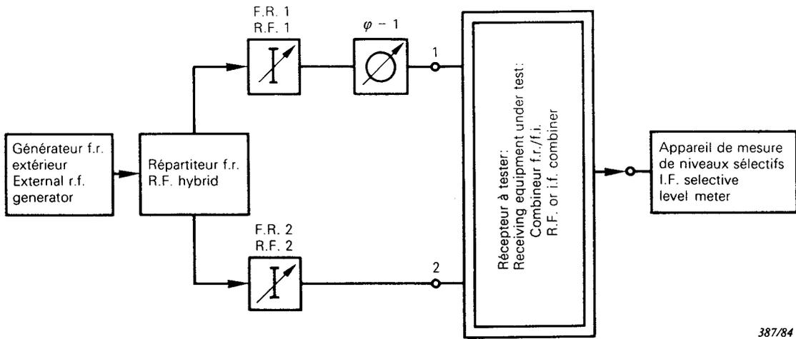
FIG. 7. — Dispositif de mesure de la caractéristique de niveau de sortie f.i. d'un combineur f.i. ou f.r.
