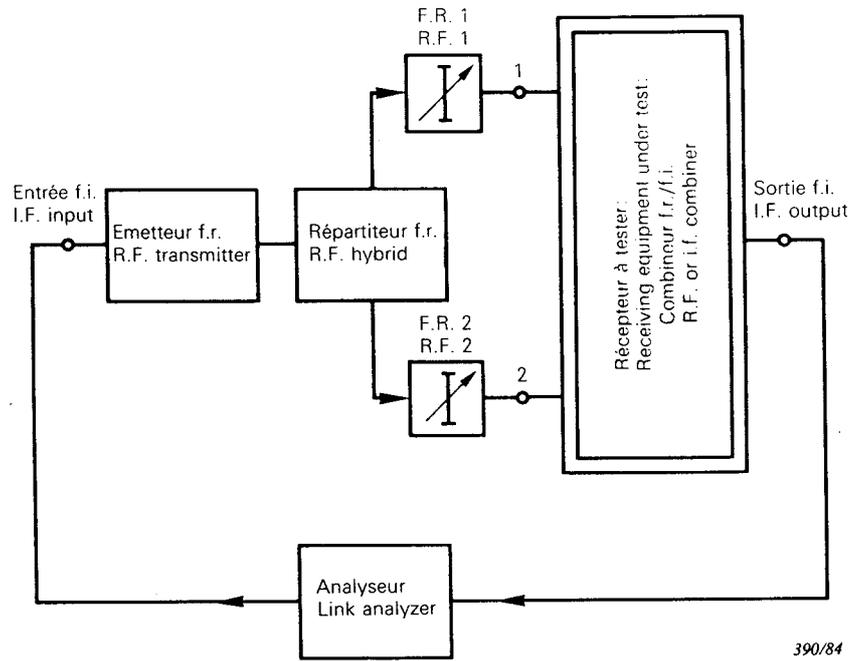
FIG. 9. — Dispositif de mesure des caractéristiques de transmission de combineurs de diversité.
