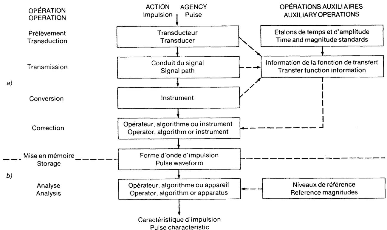
FIG. 3. - Procédé de mesure d'une impulsion :
