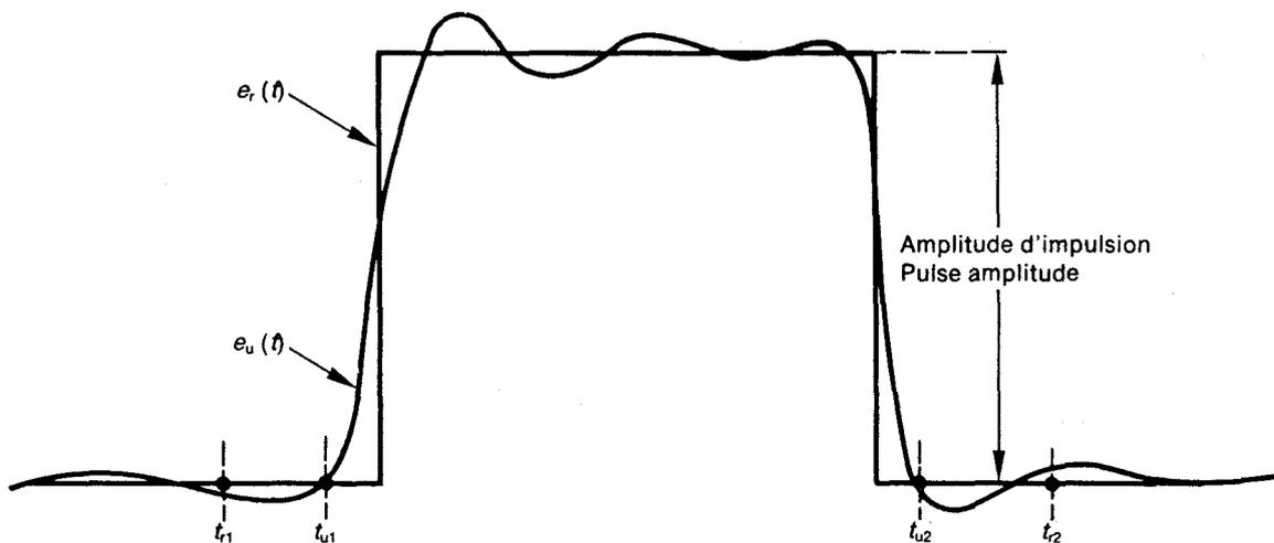
FIG. 5. - Détermination de l'amplitude d'une impulsion par la technique de l'intégration.
