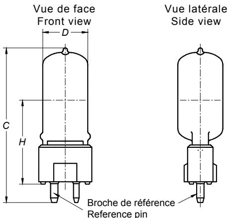
Dans la vue de face, l'ouverture des crochets du support du filament doit être de face.
