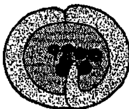
Figure 17 – Exemple de connexion à percement d'isolant dans un fût pour fil à conducteur divisé
