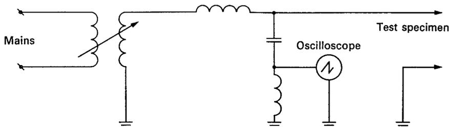
La fréquence de la résonance parallèle pour le circuit formé par l'inductance de la bobine de choc et toutes les capacités (telles que la capacité de la ligne par rapport à la terre, la capacité d'entrée de l'oscillographe, celle des fils de connexion par rapport à la terre, etc.), devra être comprise entre 0,1 MHz et 1 MHz et, à cette fréquence, l'impédance du circuit, mesurée depuis les bornes d'entrée de l'oscilloscope, ne devra pas être inférieure à 0,1 M $\Omega$ .
