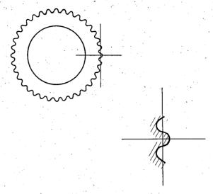
Fig. 3. — Mise en place du réticule du microscope de mesure.
