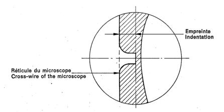
Fig. 11. — Image dans le microscope de mesure.
