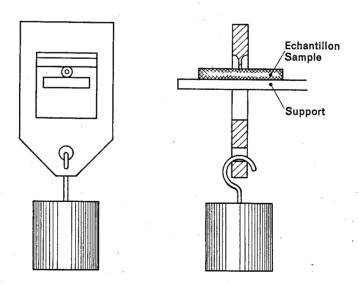
Fig. 9. — Appareil pour l'essai de pression à haute température.
