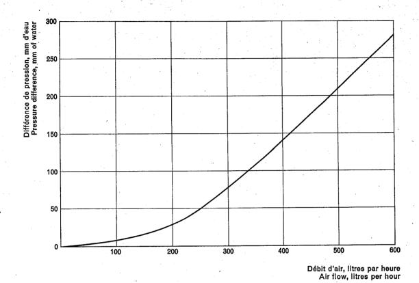
Fig. 5. — Diagramme d'étalonnage du tube capillaire (d = 2,0 mm, l = 70 mm) du débitmètre pour le contrôle du débit d'air dans les étuves par la méthode 2.
