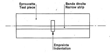
Fig. 10. — Bande étroite pour la mesure de l'empreinte.
