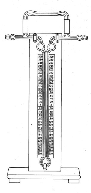
Fig. 4. — Débitmètre pour le contrôle du débit d'air dans les étuves pour la méthode 2. Flowmeter for air flow control in air ovens for Method 2.
