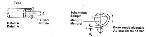
Détail B (fixation de l'échantillon) Detail B (fixing of the sample)
