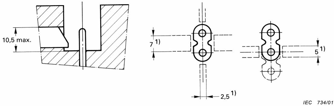
Le fonctionnement de l'interrupteur doit être réalisé 1,5 mm avant l'engagement à fond de la prise mobile.
