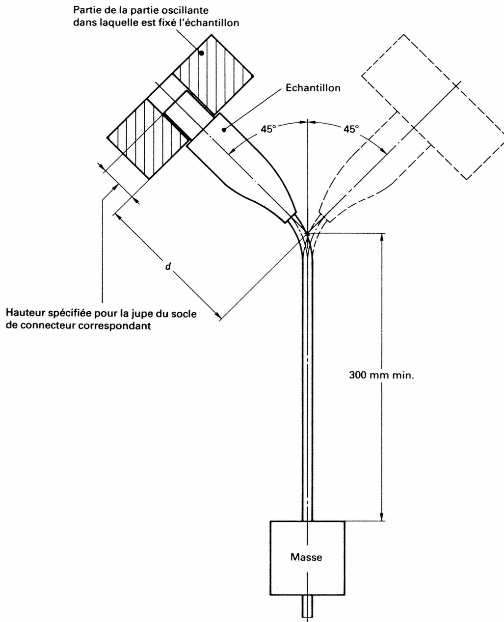
Figure 17 – Appareil d'essai de flexion (voir 22.4)
