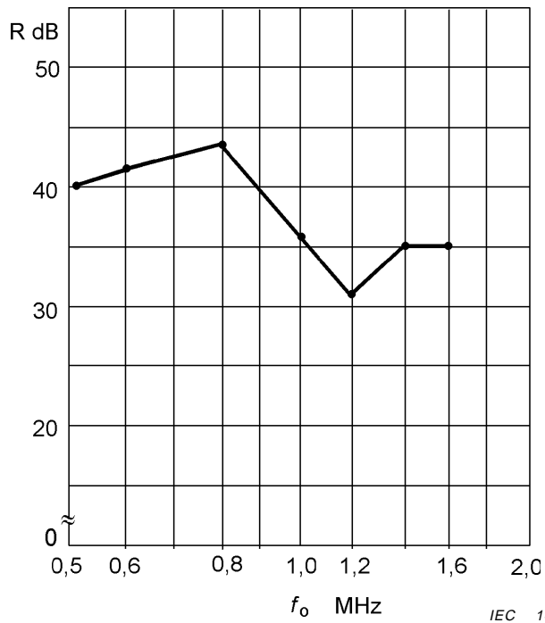
Figure 8 – Rapport de réjection d'un signal unique à la fréquence image (voir article 10)
