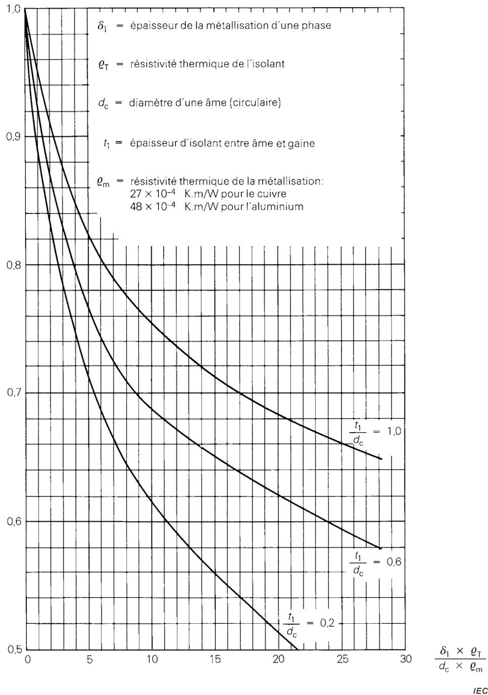
**Figure 4 – Résistance thermique des câbles tripolaires écrantés à âmes circulaires rapportée à celle d'un câble correspondant non écranté (voir 4.1.2.3.1)**
