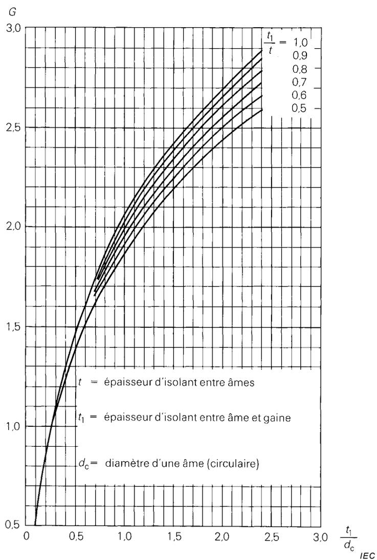
**Figure 3 – Facteur géométrique  $G$  pour les câbles tripolaires à ceinture et âmes circulaires (voir 4.1.2.2.4)**
