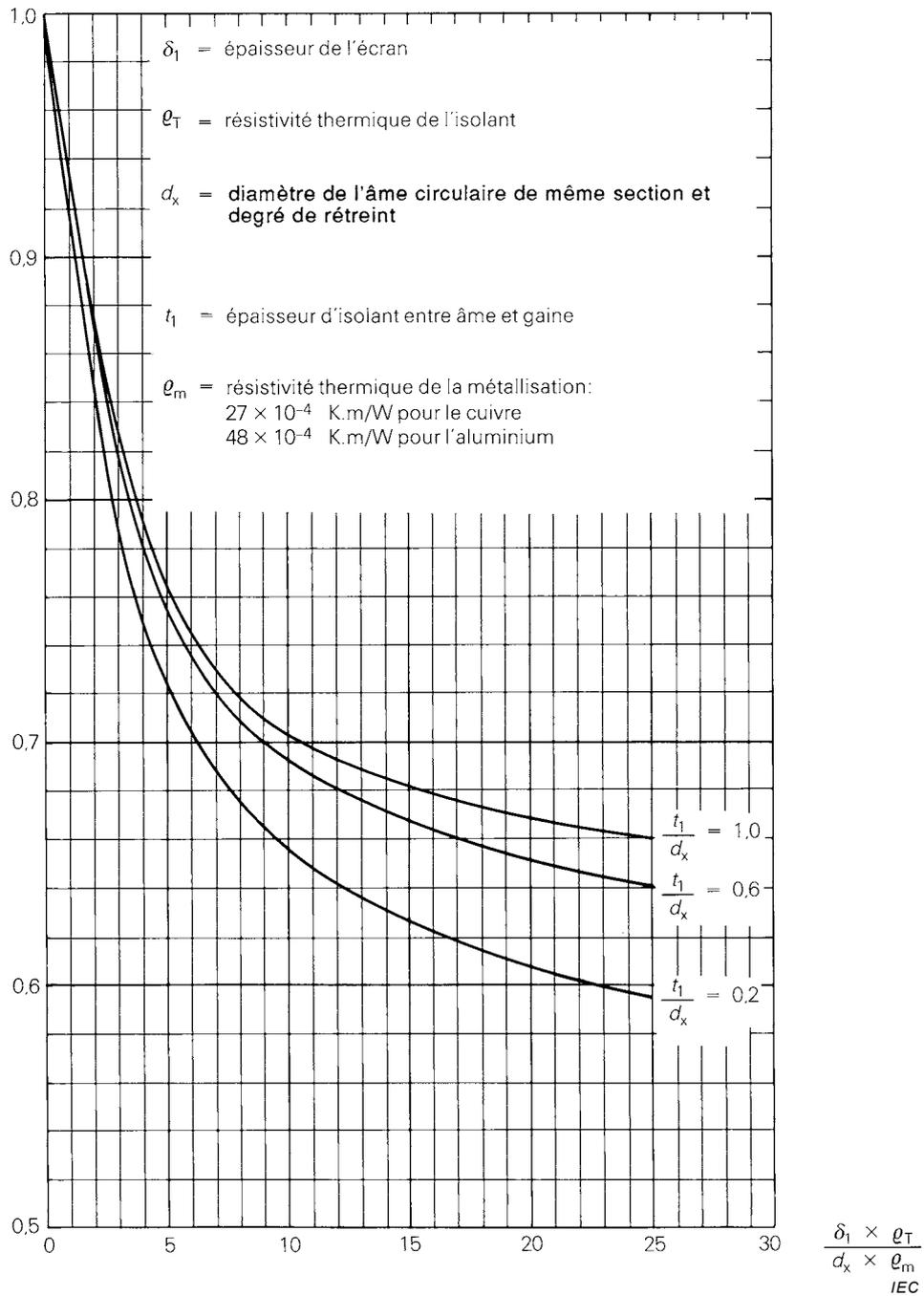
**Figure 5 – Résistance thermique des câbles tripolaires écrantés à âmes sectoriales rapportée à celle d'un câble correspondant non écranté (voir 4.1.1.3.3)**
