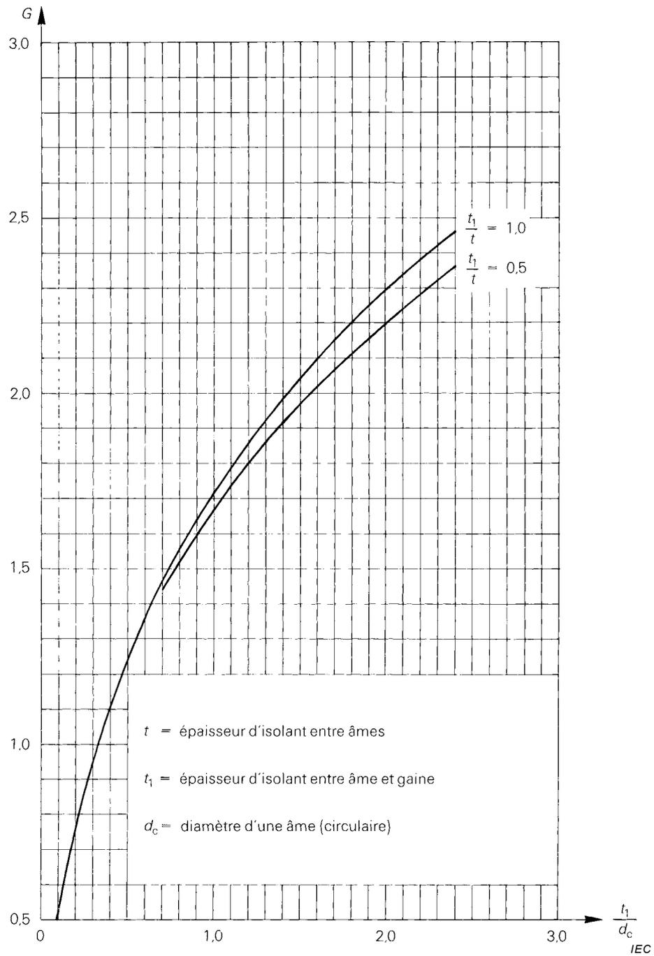
**Figure 2 – Facteur géométrique  $G$  pour les câbles bipolaires à ceinture et âmes circulaires (voir 4.1.2.2.2)**
