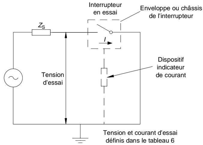
**Figure 6 – Circuit monophasé pour les essais d'établissement de courant de court-circuit, séquence d'essais 5**
