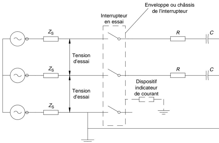
Figure 9 – Circuit triphasé pour les essais de coupure de courant de câbles à vide en cas de défaut à la terre, séquence d'essais 6b
