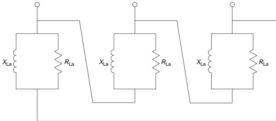
Figure 1b - Couplage de la charge en triangle
