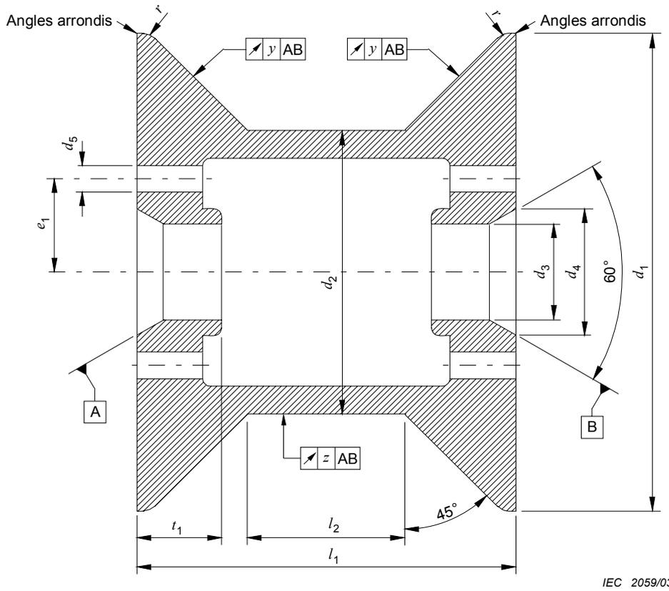
Figure 1 – Bobine de livraison à fût de forme cylindrique avec les joues coniques
