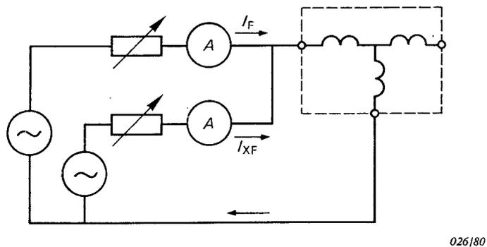
FIG. 4C. — Essai de la retenue par les harmoniques.
