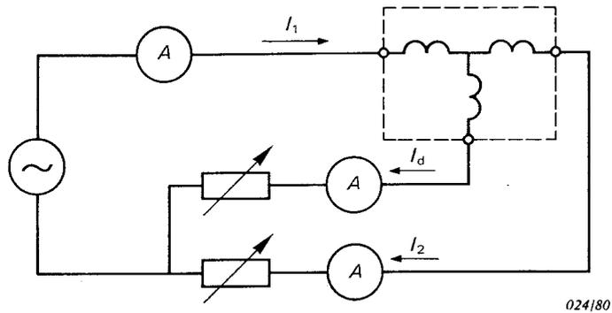
FIG. 4A. — Essai pour la détermination de la caractéristique de fonctionnement.
