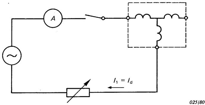
FIG. 4B. — Essai pour la détermination du temps de fonctionnement.
