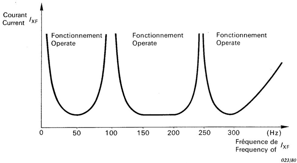
FIG. 3B. — Caractéristique de retenue par les harmoniques indiquant la réponse aux fréquences d'harmoniques différents.
