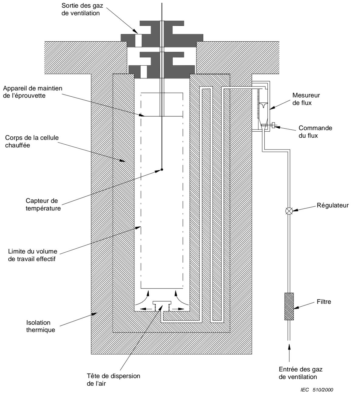
**Figure 2 – Cellule pour une étuve à chambres multiples utilisant un support solide pour le chauffage**
