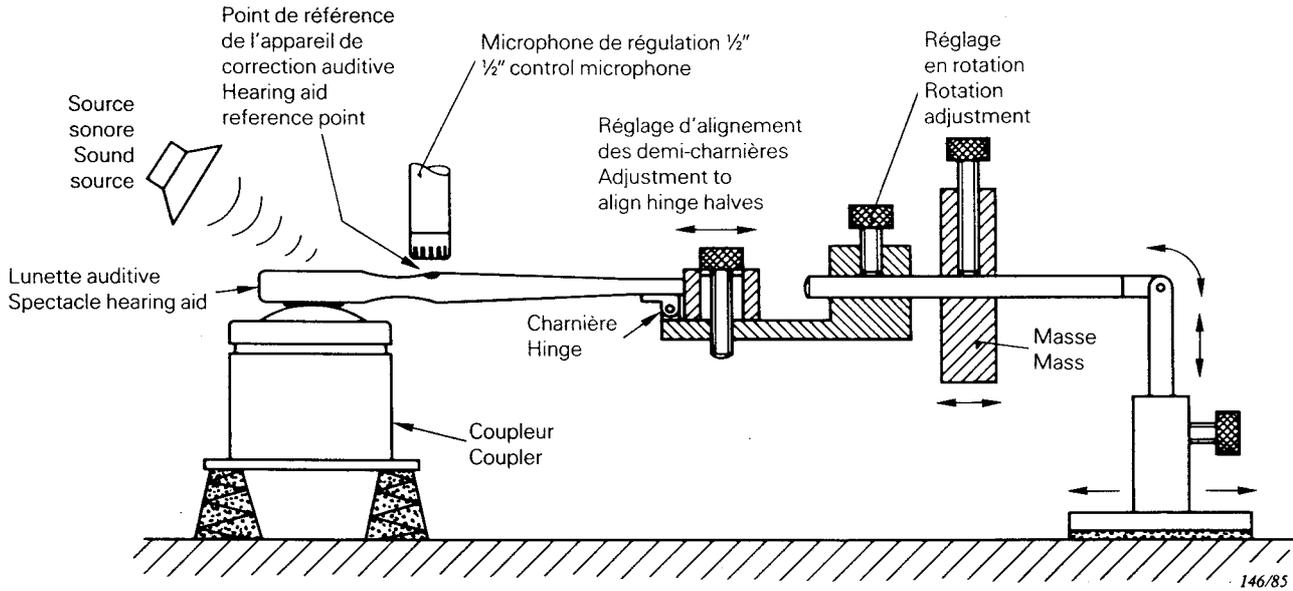
**FIG. A3.** – Exemple de montage d'essai pour une lunette auditive à ossivibrateur incorporé, la branche de la lunette étant fixée par sa charnière.
