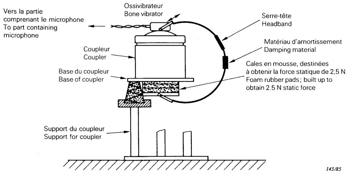
FIG. A2. – Exemple de montage d'essai sur le coupleur mécanique d'un ossivibrateur avec serre-tête.
