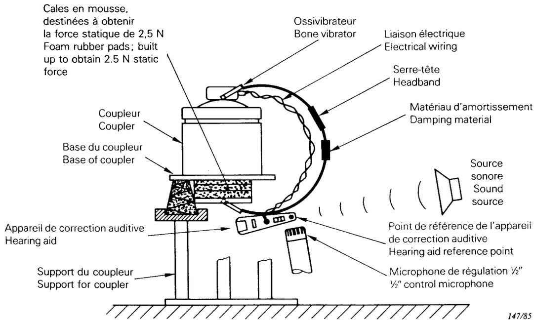
**FIG. A4.** – Exemple de montage d'essai pour un appareil de correction auditive dont le microphone et l'amplificateur sont fixés à un serre-tête, montrant l'ossivibrateur associé au serre-tête monté sur le coupleur mécanique.
