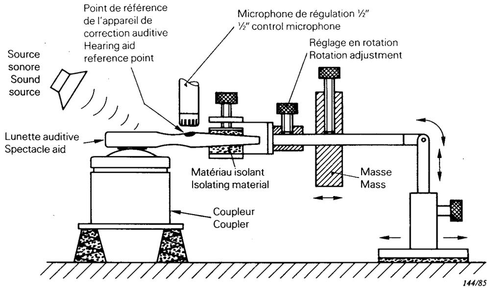
FIG. A1. – Exemple d'appareil de correction auditive à ossivibrateur incorporé en cours d'essai.
